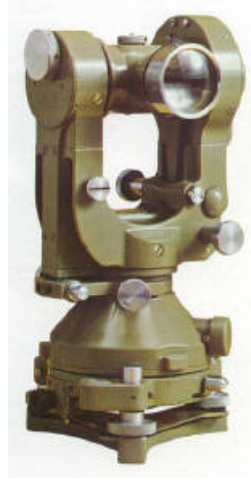
شكل (١-١٢) جهاز الثيودوليت الشهير Wild T2 للقياسات الأرضية
